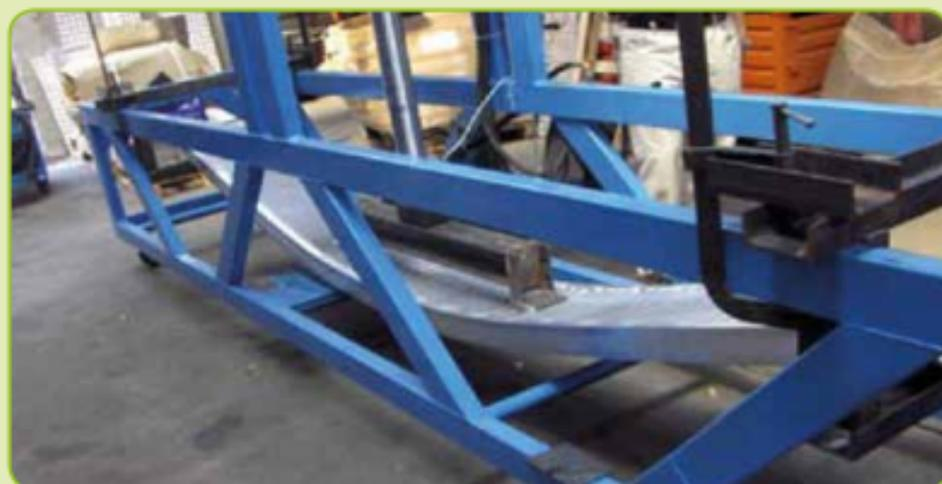
*Rampa sottoposta a rottura.*
