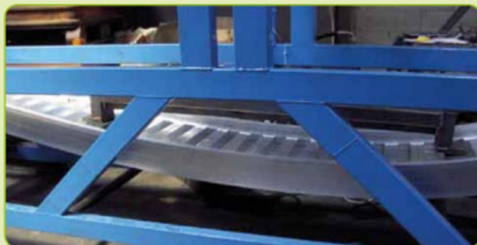
*Rampa sottoposta a rottura.*
