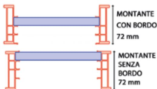
Rampe realizzate in lega di alluminio 6005; pensate per movimentare veicoli cingolati o gommati in acciaio
