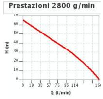
caratteristiche riferite al funzionamento con acqua a 20°
